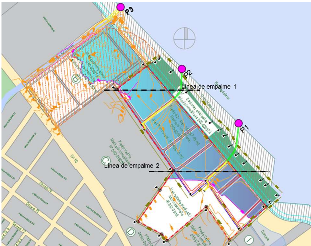
Estimación de la lámina de agua por condicionamiento de los niveles del río Magdalena. Fuente: SINTH 2022, estudio hidrológico del proyecto. Anexo “8.4.2.1 Análisis de ronda hídrica y Evaluación de riesgos componente hídrico Plan parcial Magdalena”
